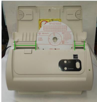
Abb. Platzieren der Schilde auf dem Scanner.
