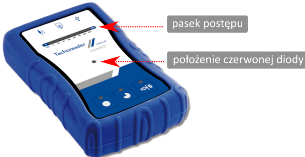
Rys. TachoReader Combo Plus - umiejscowienie wybranych elementów.
