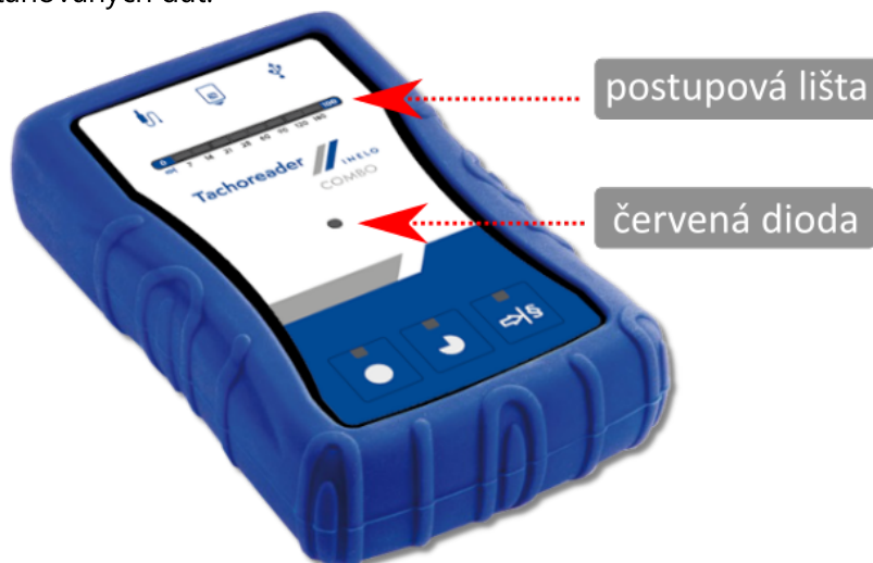
Obr. TachoReader Combo – umístění vybraných součástí.
