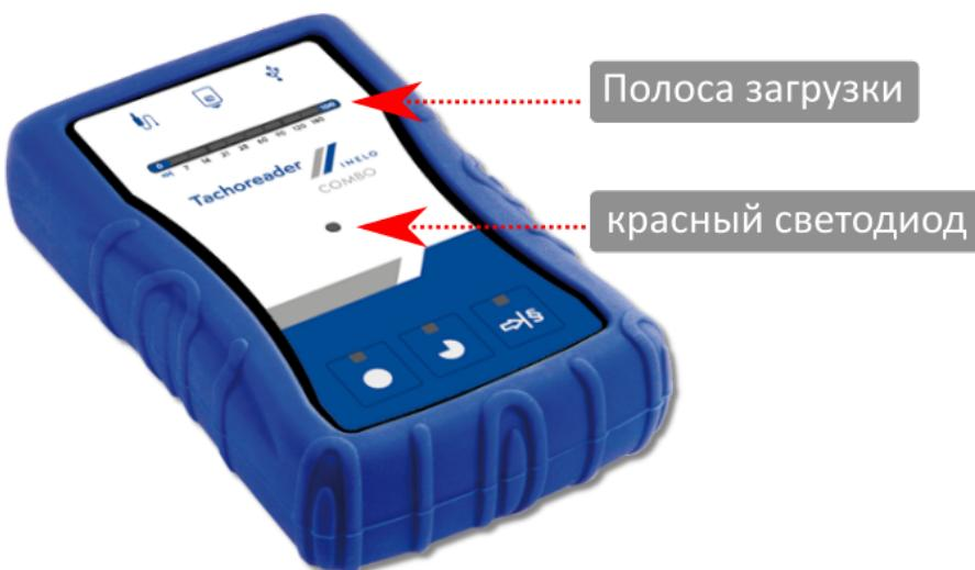
Если во время считывания данных устройство издаст 4 звуковых сигнала и полоска записи вернется к началу, означает это, что считывание данных будет продолжаться **TachoReader Combo Plus** с более низкой скоростью. Такая ситуация может появиться в тахографах «старого типа», когда считывание данных может продолжаться больше часа.
