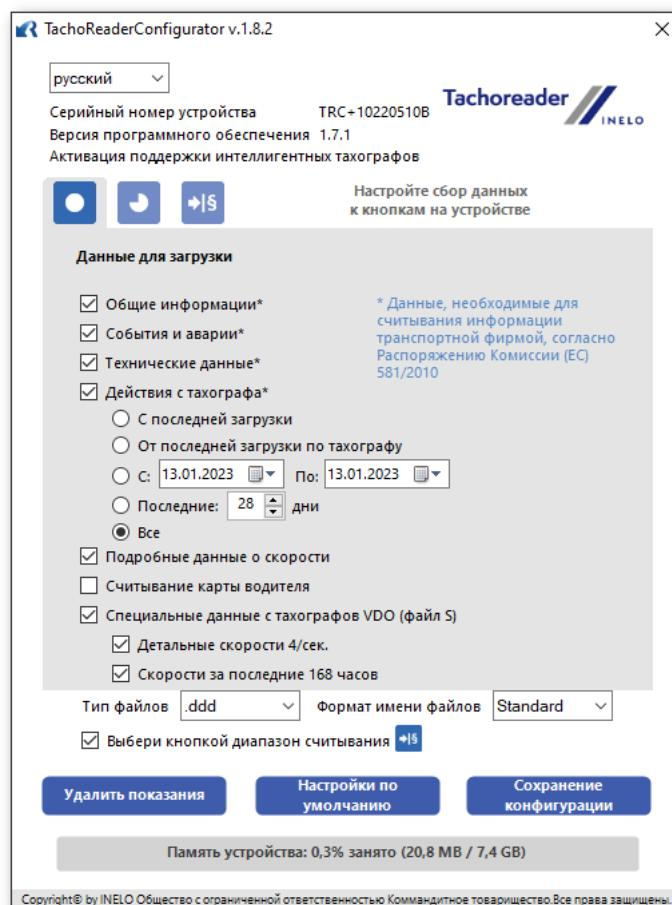
Рис. Окно конфигурации устройства: *TachoReader Combo Plus*.
