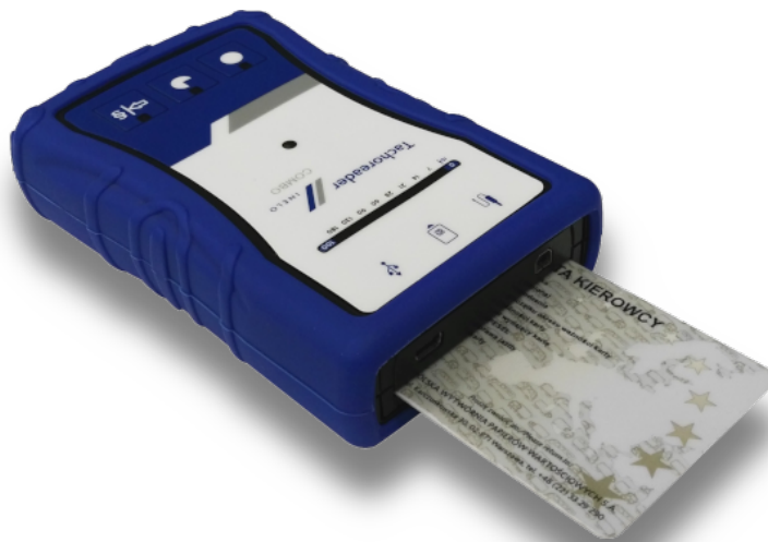
Joonis: TachoReader Combo Plus – juhikaardi sisestamine.
