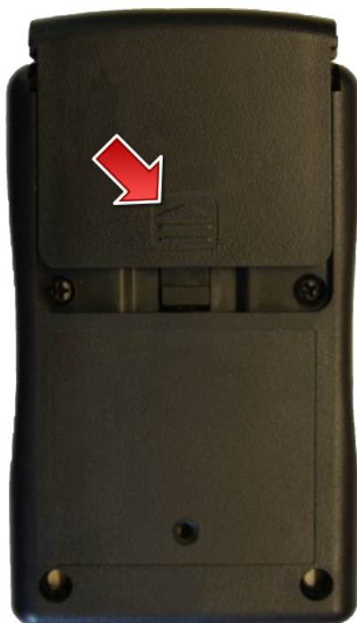
Joonis: TachoReader Combo – patareide vahetamine.
