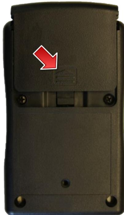
Abb. TachReader Combo - Batterien austauschen.
