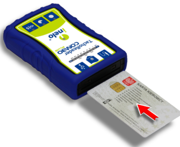
Рис. TachoReader Combo Plus – установка карточки водителя.
