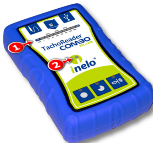
Pav. TachoReader Combo - įrenginio sandara.
