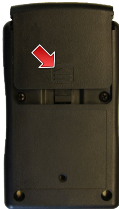
Pav. TachoReader Combo – elemento keitimas.
