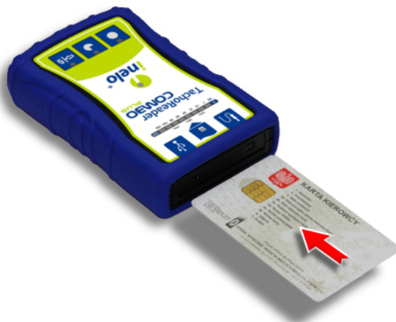
Pav. TachoReader Combo – vairuotojo kortelės įdėjimas.
