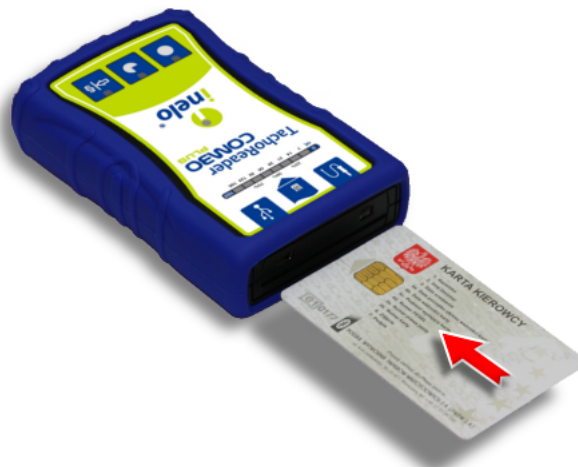
Joonis: TachoReader Combo Plus – juhikaardi sisestamine.
