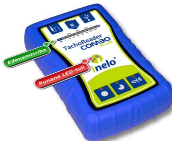
Joonis: TachoReader Combo – indikaatorid.
