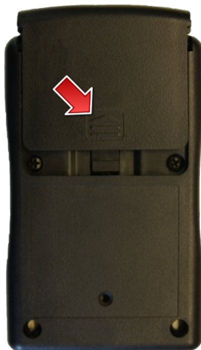
Joonis: TachoReader Combo – patareide vahetamine.
